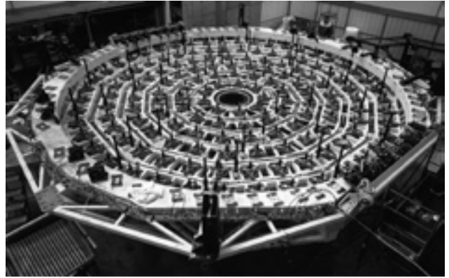
12. ábra. Az ESO VLT távcsövek aktív optikai rendszerének lelke, a főtükört támaszto és deformáló, számítógéppel vezérelt tüskerendszer (ESO)
